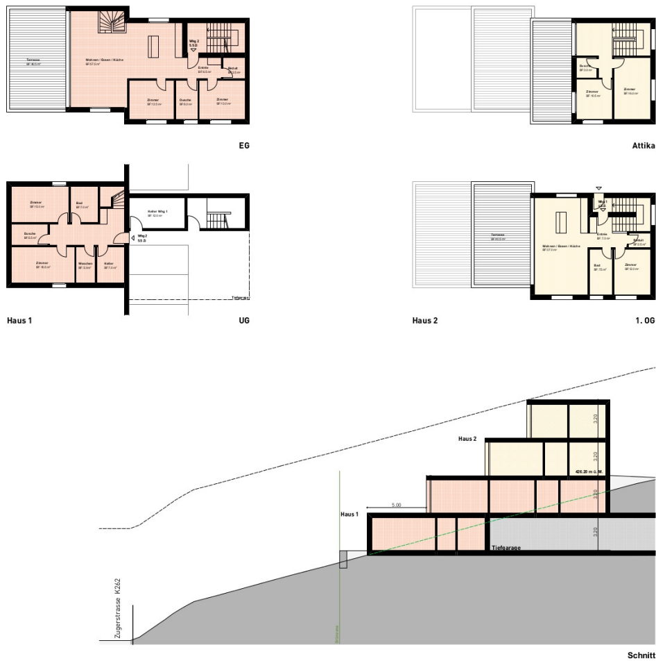
Abb.: Lärmoptimierter Grundriss
